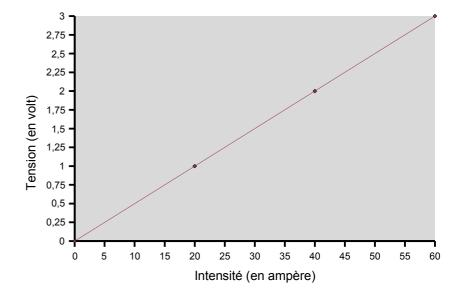
d'Ohm : U = R\*I. Cette formule peut se réécrire R = U / I et en utilisant les coordonnées du point, on a donc  $R = 3 / 0.06 = 50 \Omega$  (0.06 étant la valeur de l'intensité exprimée en ampère).
