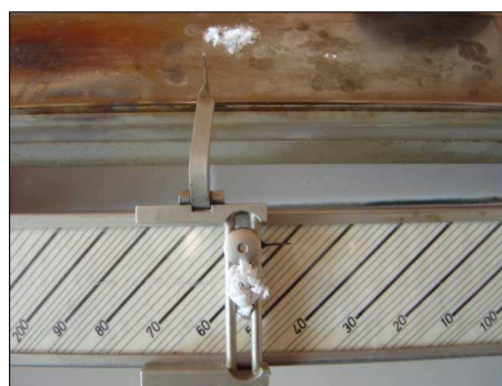
Etalonnage du banc Kofler avec de l'acide salicylique: T_{\text{fus}} = 159 \text{ }^\circ\text{C}
