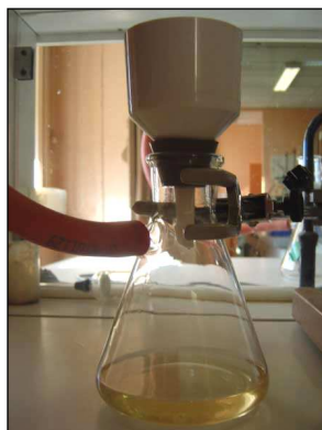
Filtration du mélange réactionnel sur filtre büchner
