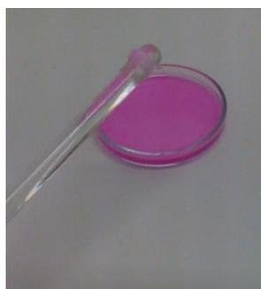
on récupère une partie du nylon que l'on enroule sur une seconde. On constate que le nylon continue de se former jusqu'à en obtenir une longueur considérable.
