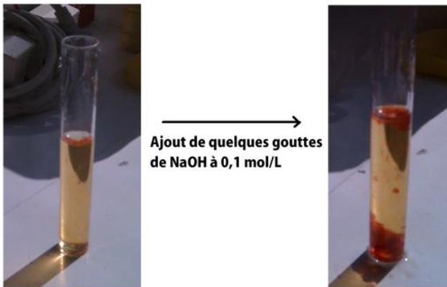
On verse une solution de chlorure de fer dans un tube à essai. Les ions  $\text{Fe}^{3+}$  forment un précipité orange de  $\text{Fe}(\text{OH})_3$  avec  $\text{OH}^-$ . Ceci nous permet de les mettre en évidence.
