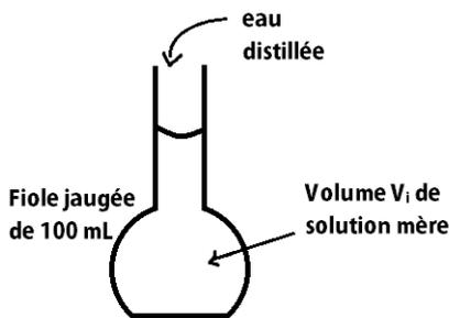
On va réaliser un dosage spectrophotométrique. Celui-ci nécessite la création d'une courbe d'étalonnage à partir de plusieurs solutions de permanganate de potassium à différentes concentrations. On part d'une solution mère de concentration  $C_0 = 1,0 \cdot 10^{-3} \text{ mol/L}$  pour fabriquer les solutions filles dont on va mesurer l'absorbance. Pour ce faire, on choisit de se placer à 525 nm où l'absorbance est maximale.
