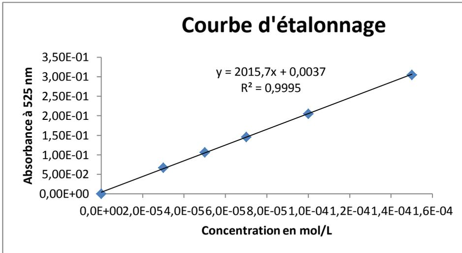
Ensuite on mesure l'absorbance de la liqueur de Dakin. On mesure  $A = 0,126$ . On en déduit que la concentration de la solution est  $C = 5,99 \cdot 10^{-5} \text{ mol/L}$ .
