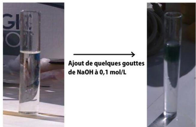
Dans un second tube à essai, on verse une solution de sel de Mohr. Cette solution contient des ions  $\text{Fe}^{2+}$ . En présence de ces derniers, un précipité vert de  $\text{Fe}(\text{OH})_2$  se forme.
