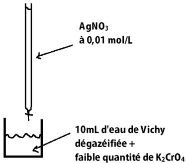
On dose 10mL d'eau minérale avec une solution de nitrate d'argent. Comme on l'a vu ci-dessus, la réaction forme un précipité blanc. Pour repérer l'équivalence, on ajoute quelques gouttes de dichromate de potassium. Les ions chromate forment un complexe rouge avec les ions argent lorsque ceux-ci sont en excès.
