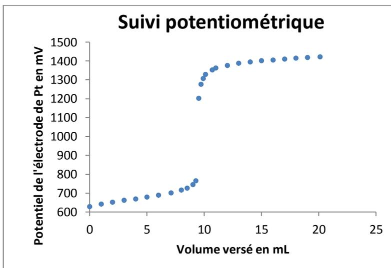
Avant l'équivalence, le couple  $\text{Fe}^{3+}/\text{Fe}^{2+}$  détermine le potentiel :
