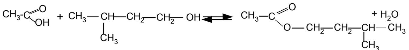
4. C'est une réaction d'estérification, elle est lente, athermique et limitée par la réaction inverse d'hydrolyse de l'ester.
