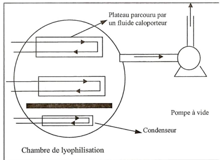
La chambre contient également un condenseur constitué d'un serpentin dans lequel peut circuler un fluide caloporteur à la température  $T_6 = 203$  K, éloigné des plateaux.
