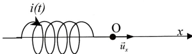
3. Trois bobines identiques sont positionnées dans un même plan avec leur axe situé à  $120^\circ$  l'un de l'autre. Elles constituent le stator d'un moteur de TGV. Le point commun  $O$ , qui relie les trois bobinages, est situé à égale distance de chaque bobine. On alimente chaque bobine par l'une des trois tensions triphasées.
