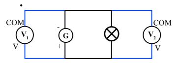
On remarque que les deux voltmètres indiquent la même valeur. Le générateur impose sa tension au dipôle récepteur.
