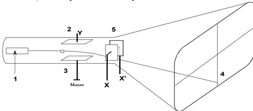
Les électrons (émis en 1) sont négatifs. Ils sont attirés par la plaque positive (3) et repoussés par la plaque négative (2). Les plaques X et X' sont branchées à un dispositif qui permet le déplacement du faisceau de gauche à droite. Le faisceau d'électrons vient frapper l'écran (4). La substance fluorescente qui le recouvre émet alors un spot.
