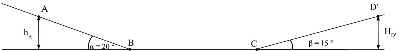
Puisque  $h_A = AB.\sin \alpha$  et que  $h_{D'} = CD'.\sin \beta$ , on a donc  $CD'.\sin \beta = AB.\sin \alpha$  et  $CD' = \frac{AB.\sin \alpha}{\sin \beta}$ .
